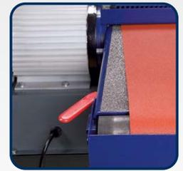
Graphitbelag auf der Schleifsohle des Bandschleifaggregats erhöht die Gleiteigenschaft und Lebensdauer des Schleifbandes
