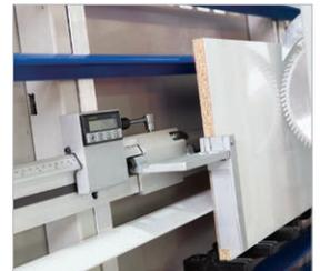
▶ **Digitale Maßanzeige zur Längeneinstellung beim Vertikalschnitt**
