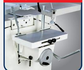
Langlochbohrereinrichtung in Guss-Ausführung
