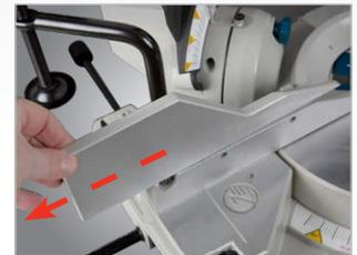
Ausziehbare Anlageschienen und ausziehbarer Tisch
