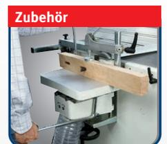
Option Langlochbohrereinrichtung mit Wescott-Bohrfutter 0-16 mm
